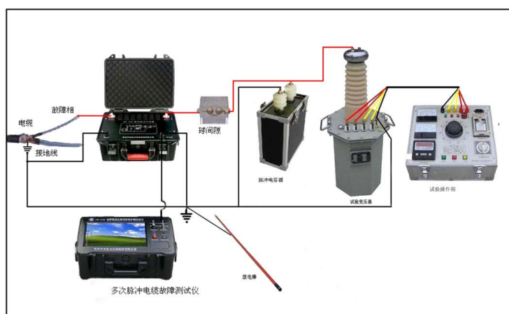
多次脉冲法现场故障测试接线示意图
