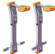
图 4-1-1 安装测深辅助传感器
