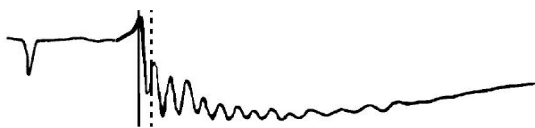
(c) 近距离故障冲闪法波形
