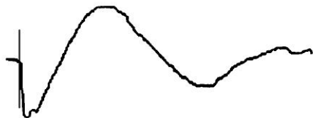
(d) 极近距离端头故障直闪法波形
