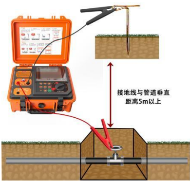
图 5- 3 金属管道直连法接线图
